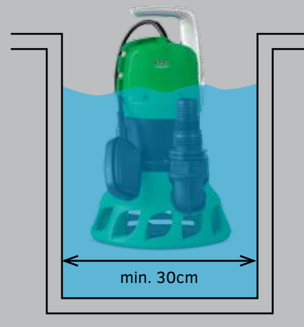
Rozměry jímky pro použití v automatickém provozu
